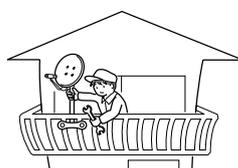
アンテナは強風の影響を受けやすいので、堅固に取り付け設置してください。
