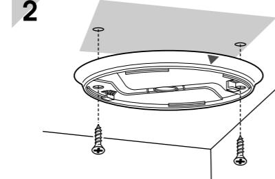
ベースを付属の取付けネジで天井の丈夫なところに取付けて下さい。
