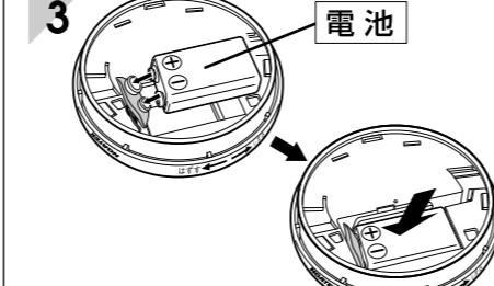
付属の動作確認用電池のフィルムを取り、極性を間違わないようにセットして下さい。
