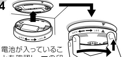
電池が入っていることを確認し、▼の印を合わせて上に押しながら「しまる」の方向に「力チツ」と鳴るまで回して下さい。
