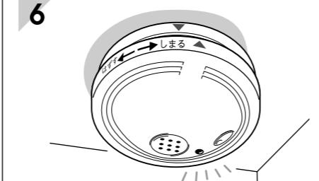
取付け完了です。作動中は約1分間隔で表示ランプが点滅します。
