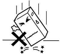
ディスクを装着したまま移動させると、ディスクが本機の内部に脱落して故障の原因になることがあります。
