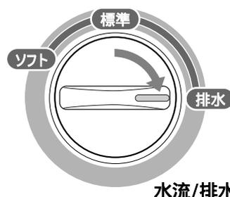
水流/排水切換を「排水」に合わせ排水します。
