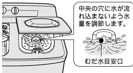
中央の穴に水が流れ込まないように水量を調節します。
