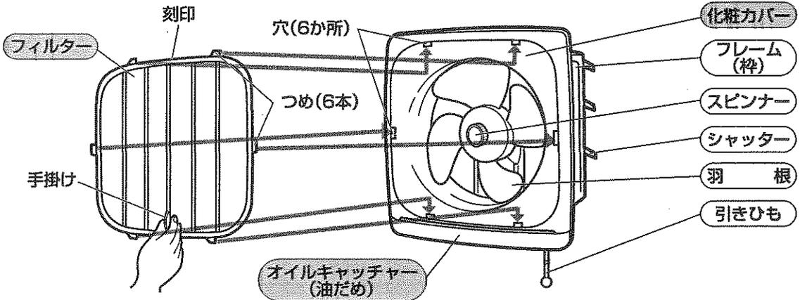
(※フィルター交換時、オイルキャッチャーを外して油の量を点検し、半分になるまでに油を捨ててください。)
